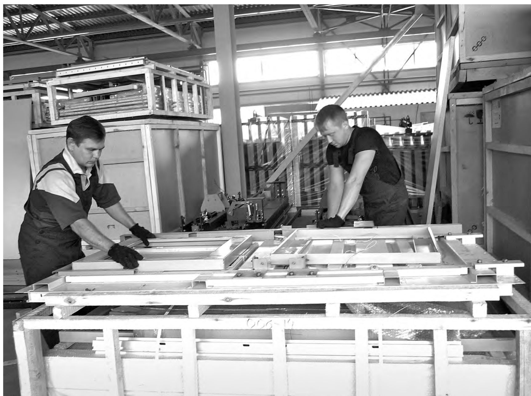
Вот так упаковывают готовый лифт перед отправкой потребителю; сборку его проведут уже на стройобъекте. Фото автора.
